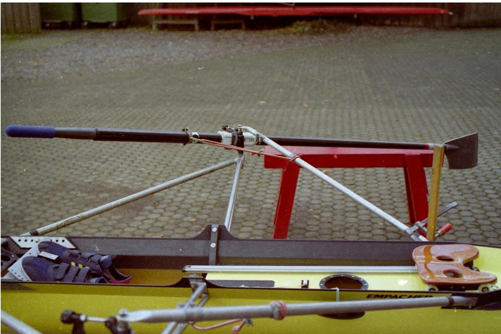
Die Schelle an der Druckstrebe soll ein Verrutschen des Gummibandes verhindern. Durch Verschieben der Schelle kann der Bremsweg justiert werden. Der Teilring an der Schelle vom Skull dient dem Karabinerhaken zur Befestigung. Vorher wird noch das Gummiband in den Karabiner gehakt. Durch den Teilring ist auch die Sicherheit gegeben, daß die Federkräfte beim Drehen des Skulls an der Längsachse desselben
