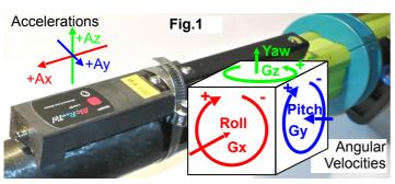
Der Referenzrahmen wurde ähnlich angesetzt wie der für die Analyse der Bootsbewegungen (RBN 2012/03) und die Sensorachsen wurden entsprechend ihrer Ausrichtung bestimmt. Fig.2 zeigt die Beschleunigungen des Ruders und die Winkelgeschwindigkeiten zusammen mit der Griffkraft und vertikalem Ruderwinkel, die wir vom Backbordskull eines M1x bei 30 spm erhielten:
