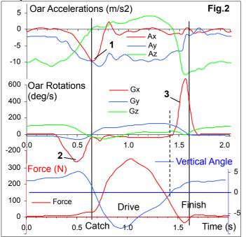
Während des Durchzuges ist der Sensor unter dem Ruder positioniert, umgekehrt zu der Position wie in Fig.1, und so hängen Ay und Gy (pitch) mit den vertikalen Bewegungen des Ruders und Az und Gz (yaw) – mit den horizontalen zusammen. Während des Vorrollens ist das Ruder um 90° gedreht (abgedreht), und so werden Ay und Gy horizontale Maße und
