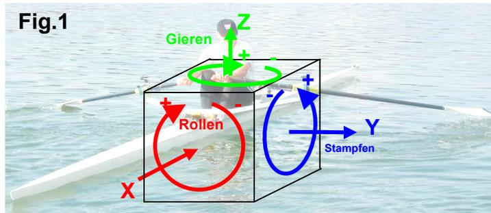
Das BioRowTel Meßsystem (1) ist mit einem 3D Gyroskop ausgerüstet, welches Messungen der Winkelgeschwindigkeiten der Rotationsbewegungen des Bootes in allen drei Achsen erlaubt. Als Vereinbarung für die Richtungen der Messungen gilt Folgendes:
